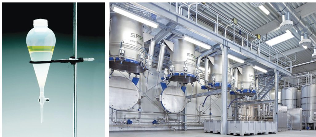
Slika 6.22. Ekstrakcija lijevkom za odvajanje (lijevo), na sličnom principu rade i moderni industrijski ekstraktori (desno)
