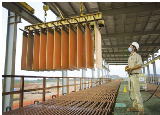
Slika 8.5. Postrojenje za elektrorafinaciju bakra, paralelno se radi sa više parova anoda-katoda od sirovog i rafinisanog bakra
