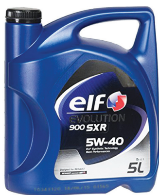
Slika 6.16. Dvije brojčane vrijednosti motornih ulja (5W-40 na slici) vezane su za njegov viskoizitet u zimskim i ljetnim uslovima. Poželjno je da ulje ima visok indeks viskoiziteta, tj. što manju promjenu viskoiziteta s porastom temperature.
