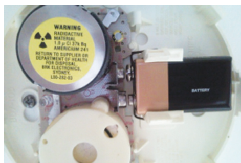
Slika 9.8 Radioaktivnim raspadom americija-241 nastaje neptunij i emituje se alfa-čestica (lijevo). Nastala emisija alfa zraka koristi se za detekciju dima i izradu protivpožarnih alarma (desno).
