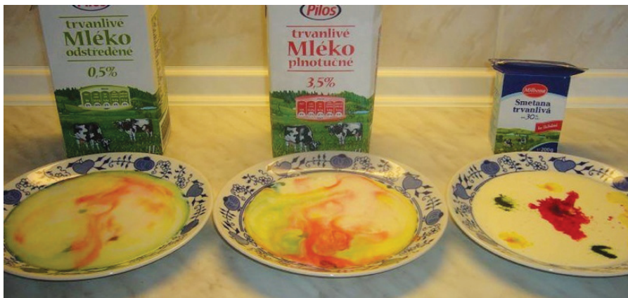
Slika 6.30. Miješanje boja u mlijeku oslikava brzinu difuzije. Mlijeko najnižeg procenta masnoće ima najmanji viskoziteti i u njemu je miješanje najbrže. U mlijeku visoke masnoće difuzija je najsporija.
