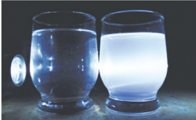
Slika 6.11. Tindalov efekt rasipanja svjetlosti na koloidnom rastvoru. Plavi dio spektra je talasnom dužinom najbliži dimenzijama koloidnih čestica pa se u rasutoj svjetlosti primjećuje nijansa plave boje. Pravi rastvor ostaje optički proziran.
