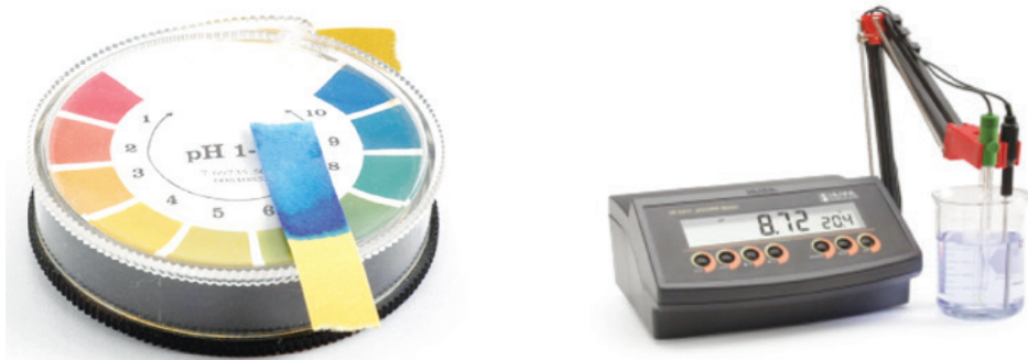
Slika 7.24. Indikatorska traka (lakmus papir) služi za brzo i okvirno određivanje pH vrijednost (lijevo), obično ima crvenu boju u kiseloj sredini, a plavu u alkalnoj. Precizno mjerenje pH sredine obavlja se pH-metrom (desno)
