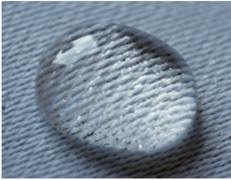
Slika 6.17. Kohezione sile vode manifestuju se težnjom kapljice za minimalnom površinom (lijevo). Površinski napon vode omogućava neke neobične pojave u prirodi (desno).
