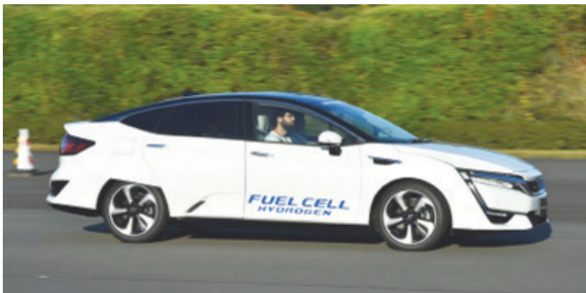
Slika 8.21. Automobil pokretan energijom iz gorivih članaka (fuel cell), a gorivi članak može biti i dodatni pogon u hibridnim modelima
