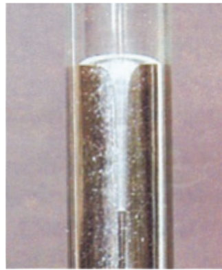
Slika 6.18. Oblici meniskusa žive i vode u staklenoj kapilari
