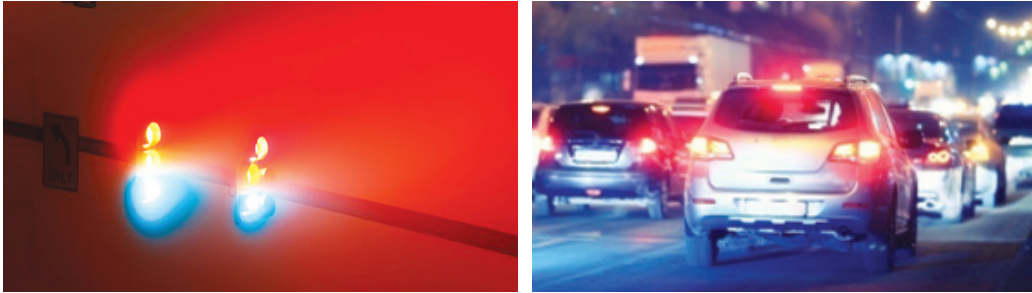
Slika 6.13. Zaustavno svjetlo semafora je crvene boje jer ima duži domet i bolju vidljivost u daljini. Koćiona svjetla crvene boje igraju važnu ulogu u uslovima otežane vidljivosti. Jasna vidljivost vozila ispred je važna za siguran saobraćaj. Tehnički pregledi i policijske kontrole vozila, između ostalog, obavezno provjeravaju i ispravnost koćione signalizacije.
