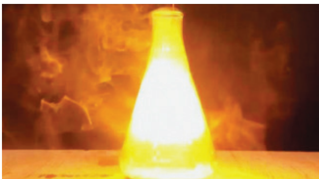
Slika 5.7 Sagorijevanje natrija u hloru. Reakcija oslobađa znatnu količinu energije u obliku toplote i svjetlosti.
