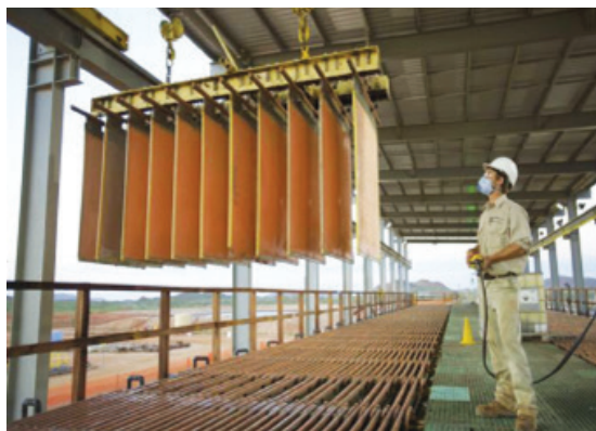
Slika 8.5. Postrojenje za elektrorafinaciju bakra, paralelno se radi sa više parova anoda-katoda od sirovog i rafinisanog bakra
