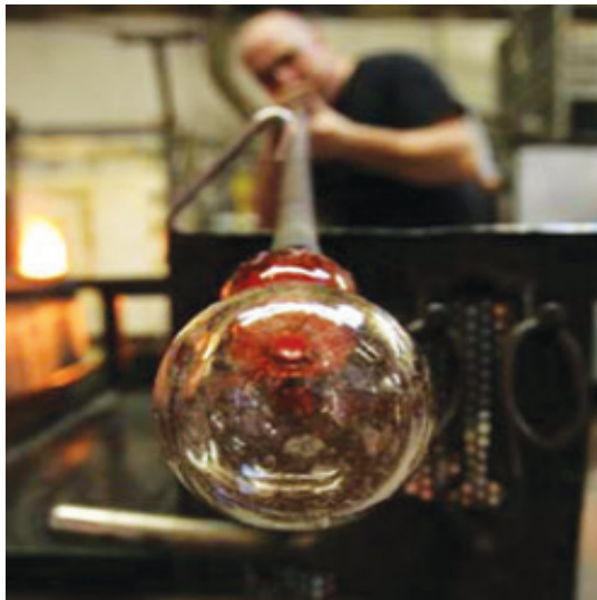
Slika 1.4. Puhanje stakla, termičko oblikovanje stakla omogućeno je njegovom amorfnom strukturom
